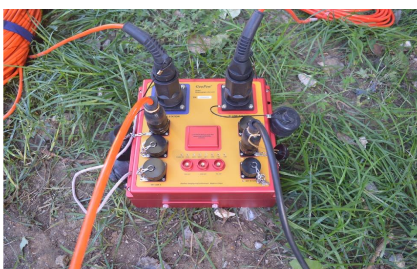
混合遥测交叉站 Telemetry cross station
