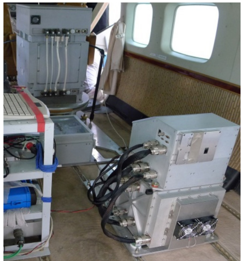
捷联式航空重力仪与 GT-2A 系统同机飞行实验 experiment with Strapdown Airborne Gravimeter and GT-2A
